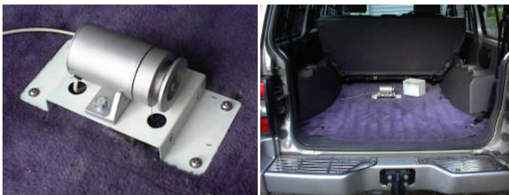
El "Bump Integrator" está compuesto por un dispositivo mecánico que registra el movimiento relativo entre la carrocería del vehículo en que va montado y el centro del eje donde van montadas las ruedas. Con este equipo la medición se realiza a la velocidad de circulación o una velocidad definida por el vehículo de medición. Este equipo entrega como resultado el índice BI el cual se correlaciona para obtener el IRI cada 200 metros.
