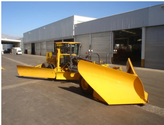
Motoniveladora equipada con espolón central y hoja lateral para despeje de nieve
